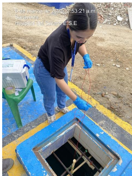
Fotografía. 4 Toma de muestras después del lavado del 05/03/2025
