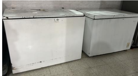
Refrigeradores en mal estado, tapas sin cauchos y sin seguridad, se encuentran oxidadas.
