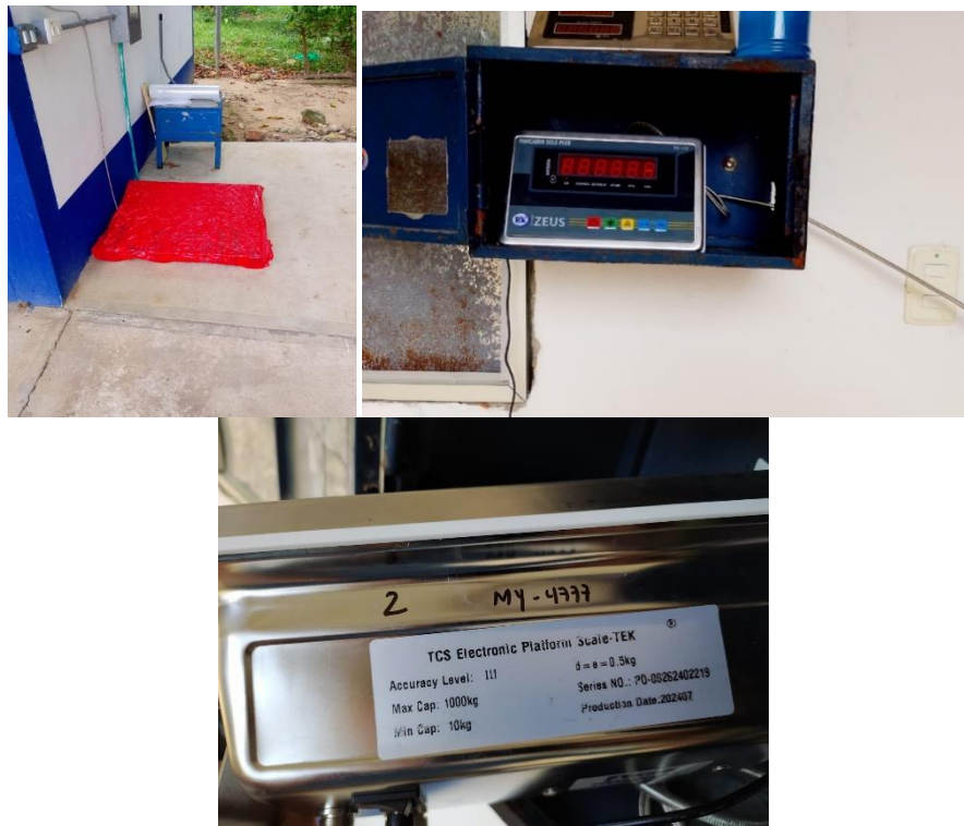
Ilustración 4Basculas instaladas en depósito central de residuos
